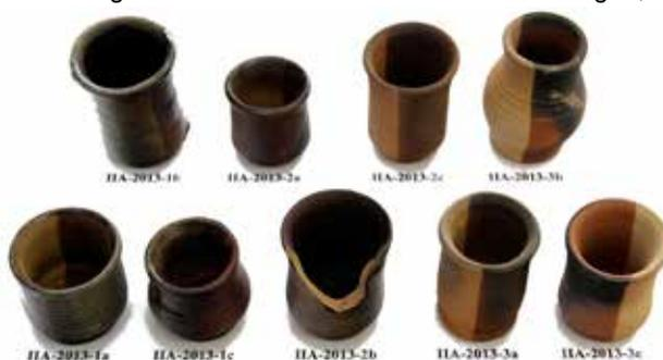
Abb. 2. Experimentelle Keramiken aus verschiedenen Bereichen des Ofens. Alle Keramiken stammen aus dem gleichen Ausgangsmaterial und sind aufgrund ihres Standorts im Brennofen in unterschiedlichsten Sinterungsstufen entwickelt.
