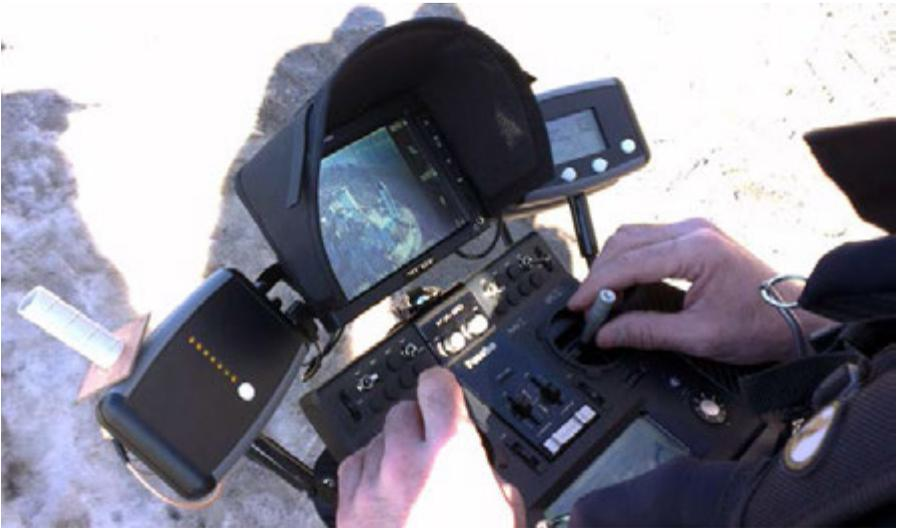
Via Fernsteuerung hat der Pilot jedes Bild in Echtzeit im Blick, das in das fliegende Auge der Drohne fällt
